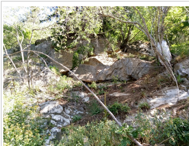
Foto 30: Vista dal basso della situazione C. Si nota la frattura molto aperta sulla quale poggia la porzione d'ammasso disarticolata.
