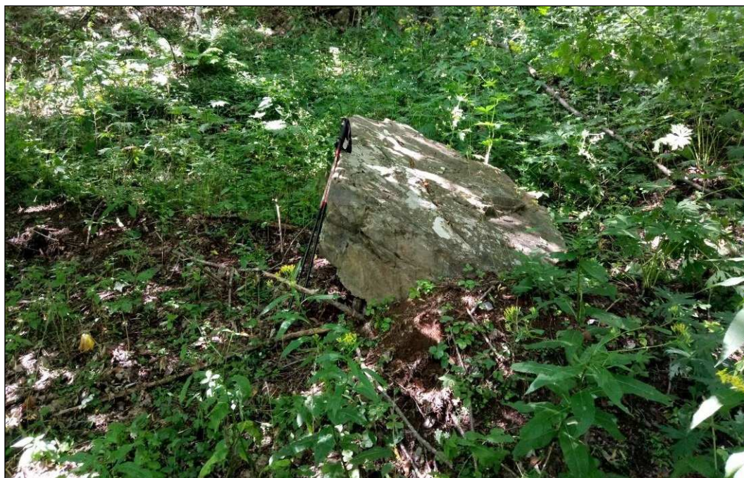
Foto 22: Vista di un blocco di circa 0,8 \text{ m}^3 distaccatosi molto recentemente dal settore 7 ed arrestatosi per infossamento nella coltre superficiale fine.
